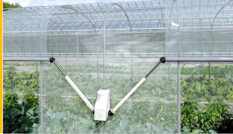
**Ручной редуктор для вентиляции прямым раскатыванием 1/8<sup>я</sup>
